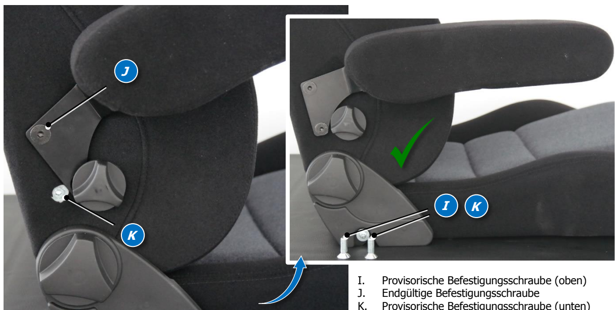
Abb. 8 Montage der Armlehnen (Option) - Endgültige Befestigungsschrauben einschrauben und festziehen
