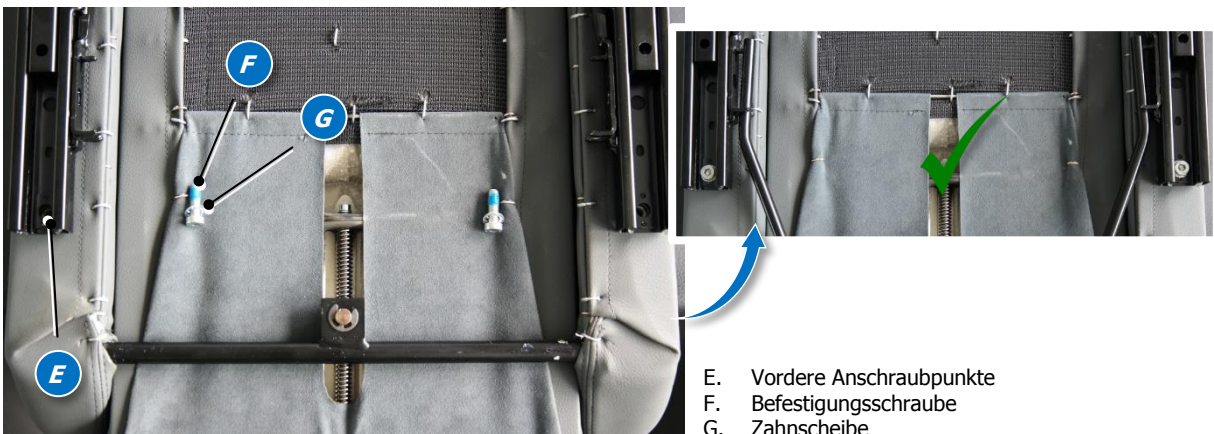
Abb. 3 Montage der Laufschiene(n) (Option) - Vordere Befestigungsschrauben einschrauben und festziehen
