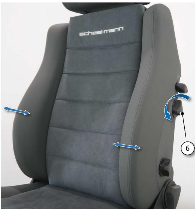
Abb. 19 Seitenwangenverstellung in Rückenlehne
