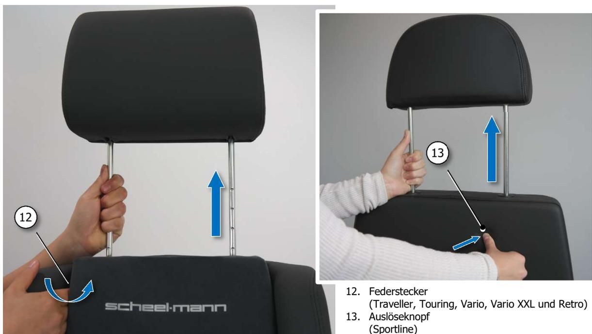
Abb. 15 Entfernen der Kopfstützen
